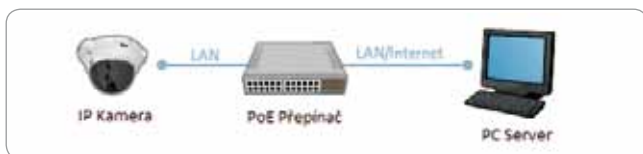
Obr. Schéma zapojení IP kamery prostřednictvím PoE (Power over Ethernet)
